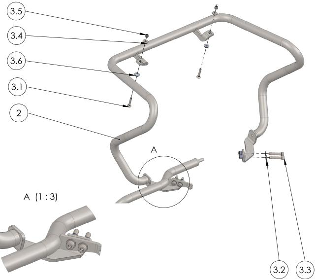
Schraubverbindung mit unterem Sturzbügel Art.-nr.: 935889B
