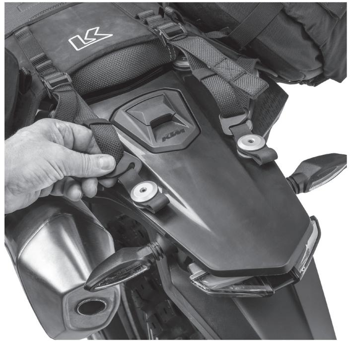
**2** Stellen Sie die oberen Gurte auf die längste Länge ein und schieben Sie die elastische Schlaufe fast bis zur Schnalle. Haken Sie jeden oberen Gurt in die hinteren OS-RACK LOOPS ein.
